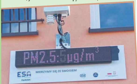
Dane zbierane przez czujniki będą przesyłane do centralnego serwera i uśredniane w 5-minutowych okresach pomiarowych.
